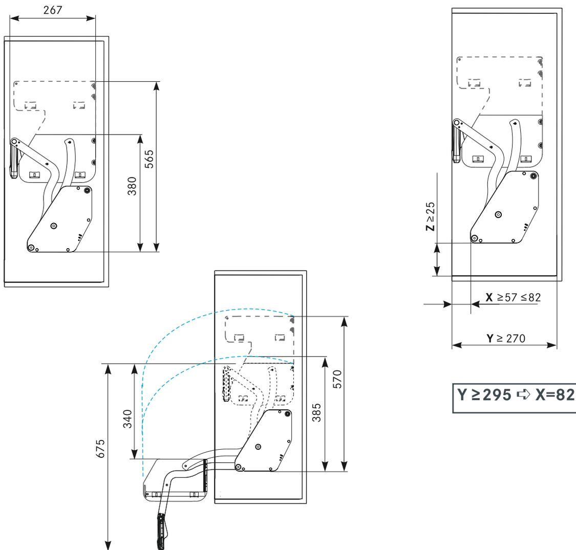
Schema di foratura per linguette di posizionamento
