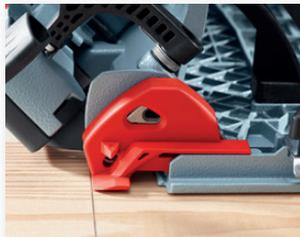
Regolando la sporgenza della lama dal piano la protezione mobile della lama si aziona automaticamente e garantisce maggiore confort e sicurezza nei tagli a immersione e nei tagli trasversali.
