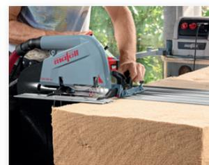
Con la DSS 300 cc è possibile lavorare anche materiale isolante flessibile (ad esempio per inserti) in modo rapido e preciso.
