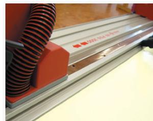
Mediante il sistema aspirante MAFELL S 50 M e il canale aspirante integrato l'aspirazione delle polveri è pressoché completa.
