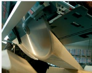
La sega circolare MKS 130 Ec è l'utensile ideale per realizzare tagli obliqui, poiché è possibile inclinare la lama fino a 60°, ottenendo così una profondità di taglio di ben 65 mm.
