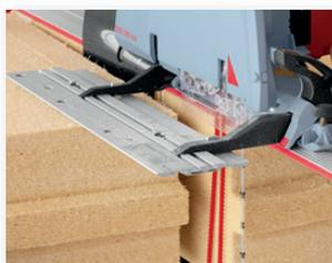
Grazie alla perfetta integrazione dei vari elementi del sistema e alle caratteristiche innovative quali la particolare lama a filo, il cuneo di guida in carbonio e il dispositivo per rimuovere i trucioli l'utensile garantisce una qualità di taglio ad alta precisione.
