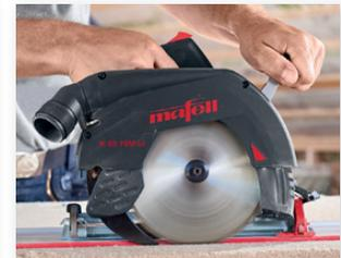
Il dispositivo FLIPPKEIL permette di realizzare tagli a immersione in maniera flessibile e sicura senza dover smontare il coltello divisore.
