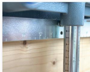
È possibile regolare esattamente la distanza verticale dal bordo tramite una scala.
