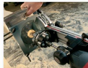
La battuta parallela, utilizzabile per esempio per eseguire fori su legno massello, permette di realizzare, in combinazione con la battuta laterale, pezzi di lavorazione in serie.
