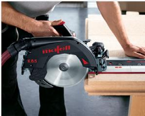
Grazie al sistema speciale di inclinazione si ha la possibilità di tagliare con qualsiasi inclinazione direttamente lungo la guida.
