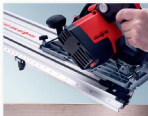
Al termine del passaggio di lavorazione una molla farà sì che la fresatrice ritorni alla posizione iniziale.
