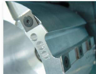
La nuova testa portafresa con le sue placchette ribaltabili in metallo duro comporta un'insuperabile capacità di truciatura, migliorando nel contempo l'evacuazione dei trucioli.
