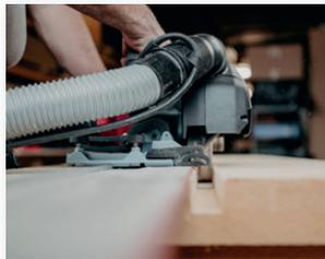
Con la fresa per scanalature regolabile come accessorio speciale si possono creare scanalature di 22 - 40 mm.
