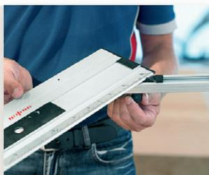
L'ampiezza in gradi necessaria per la battuta angolare viene impostata semplicemente tramite lo scalimetro, grande e ben leggibile, e fissata tramite l'apposito arresto.
