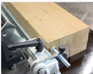
Il profilo di battuta lungo 3 m, dotato di una scala millimetrata, così come le battute longi-tudinali, consentono un preciso posizionamento dei pezzi in lavorazione.
