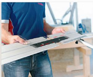
La battuta angolare può essere unita a tutte le barre guida F con l'ausilio di un adattatore. È semplice: basta applicare l'adattatore, accostarlo e arrestarlo. Fatto.
