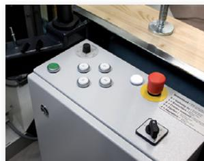
Ben visibili e disposti ordinatamente - i comandi della tenonatrice ZAF 250 Vario per il funzionamento in automatico o manuale.
