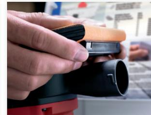
L'arresto meccanico per la carta in rotoli tende la carta abrasiva con estrema precisione senza la formazione di pieghe.
