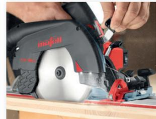
Il dispositivo FLIPPKEIL permette di realizzare tagli a immersione in maniera flessibile e sicura senza dover smontare il cottello divisore.
