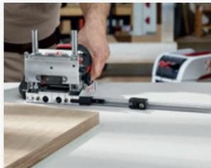
Il sistema di battute brevettato con perni di arresto a molla nella piastra base è stato semplicemente adattato alla nuova battuta laterale SA 320.
