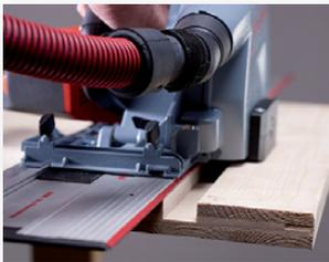
Grazie al dispositivo MF-VN 25 è possibile realizzare scanalature per tavole di tamponamento o cavi di alimentazione in poco tempo.
