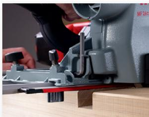
Per realizzare tagli di fughe trasversali si consiglia l'uso del Dispositivo di guida M ad esempio per tavole di tamponamento ecc..
