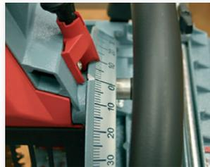
Scala di facile lettura. La regolazione a scatti  $-45^{\circ}/+45^{\circ}$  permette di impostare l'angolazione di taglio in modo veloce e facile.
