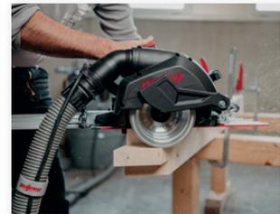
Con la NFU 50 e il dispositivo di guida L si possono realizzare tenoni individuali senza sforzo.
