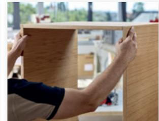
La collaudata tecnica a doppio foro impedisce che i pezzi in lavorazione si possano torcere l'uno contro l'altro dopo la giunzione. In questo modo si elimina la necessità di allineare i pezzi.
