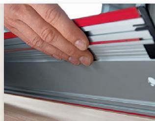
Due binari a incastro posti sulla parte inferiore della guida garantiscono una presa sicura e garantiscono l'assenza di tracce sul pezzo di lavorazione.
