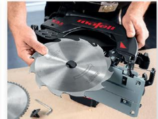
Con una impostazione possiamo bloccare la sicura e il motore per andare ad effettuare un cambio lama sicuro.
