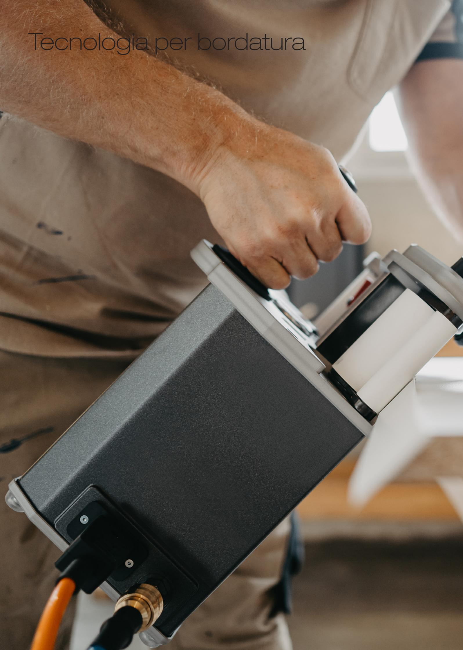
**La HIT-M è il primo e unico dispositivo mobile per creare un giunto zero ottico. La tecnologia ad iniezione di aria calda consente di lavorare tutti i bordi a giunto zero convenzionali con lo strato funzionale applicato - senza necessità di usare dell'adesivo aggiuntivo.**
