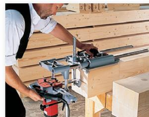
Fresature di grande precisione su giunti e travi per l'edilizia in legno.
