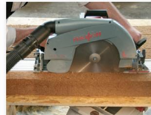
In combinazione con l'aspiratore S 50 M e la guida a binario la sega circolare MKS 130 Ec garantisce tagli puliti e precisi, anche nel caso di materiali per l'isolamento difficili da lavorare.
