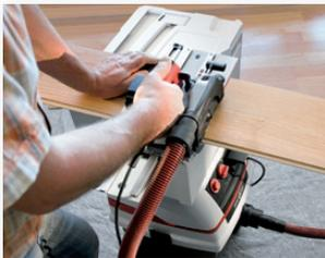
Il T-MAX fissato sul sistema di aspirazione può servire da piano d'appoggio per i piccoli pezzi da lavorare.
