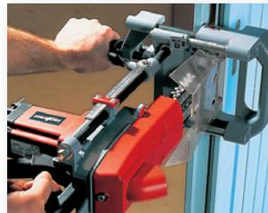
Nessun problema: è possibile mortasare incassi per serrature in modo veloce e preciso anche su porte già montate.
