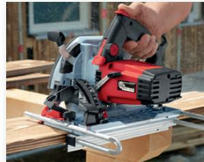
Le guide con scala millimetrica MAFELL oppure le battute parallele con scala millimetrica (in dotazione) aiutano a tagliare le perline per il terrazzo con la massima precisione.
