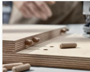
L'applicazione di fori a interasse di 32 mm fa parte della routine professionale. La spinatrice doppia DDF 40 può essere utilizzato anche per praticare serie di fori da 32 mm e fori di fissaggio – e quindi assemblare mobili completi.
