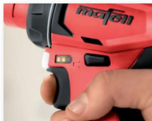
Il livello di carica della batteria è sempre leggibile in qualsiasi momento. Anche senza dispositivo.
