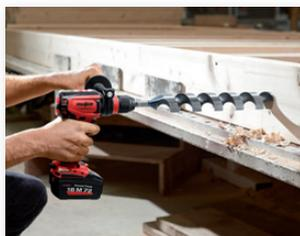
La foratura di legno massiccio con una punta di diametro 50 mm con la A 18 M e la ASB 18 M è facile e senza troppo impegno.
