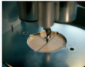
Con i segni di tracciatura è facile portare la punta del trapano nella corretta posizione. Anche in posizione di lavorazione inclinata la punta risulta sempre allineata rispetto all'asse.
