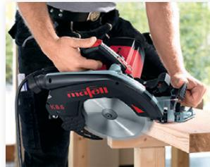
Grazie alla manopola per il rientro della protezione della lama abbiamo un utilizzo della macchina semplice, facile e sicuro.
