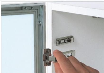
**4)** Procedere al montaggio della cerniera sul telaio finito dopo aver fissato le cerniere alle basi. L'operazione non richiede nessuna lavorazione sull'anta, in quanto la cerniera può essere inserita in qualsiasi punto dell'anima interna del profilo.
