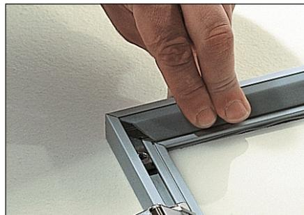
**8)** Completare la preparazione dell'anta inserendo con una semplice pressione il profilo di copertura interno.
