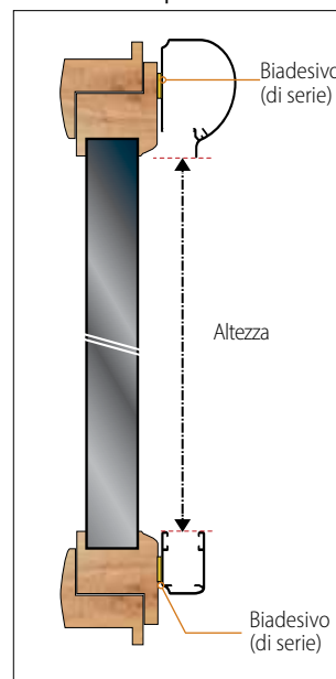
Rilevazione della misura vetro per l'attacco frontale
