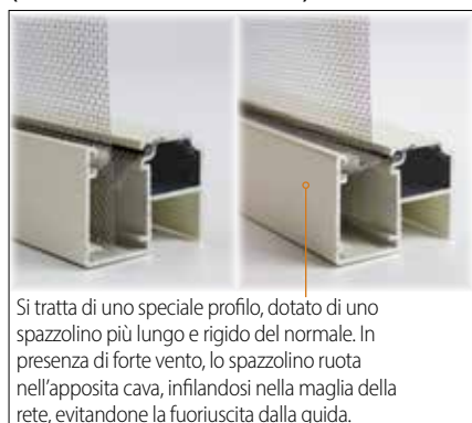
Guida con sistema antivento (brevetto internazionale Bettio)
