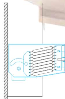
**6. Regolazione tensione mobile portare il letto in posizione orizzontale, e regolare la tensione delle molle per ottenere il perfetto equilibrio. Questo può essere verificato assicurandosi che il letto rimanga fermo in qualsiasi posizione di apertura. L'aria tra il cassonetto e i fianchi del mobile deve essere di 32/33 mm per parte.**
