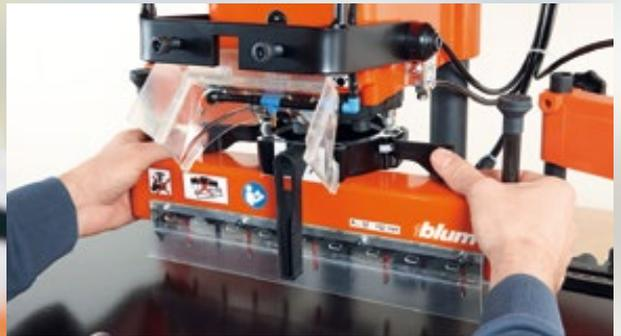
La testa portapunte a 9 mandrini per eseguire gruppi di fori con schema da 32 mm e la testa portapunte a 8 mandrini per la lavorazione del frontale e della guida fianco possono essere montate senza attrezzi.
