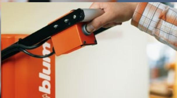
Per eseguire i fori con precisione la leva si abbassa manualmente.
