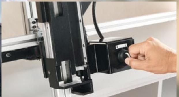
I componenti del cassetto vengono fissati pneumaticamente e in seguito avvitati.
