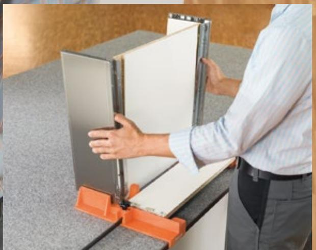
BOXFIX E-L vi supporta in modo ottimale: i componenti del cassetto possono essere montati con precisione e senza fughe senza dover assumere posizioni scomode per fissarli.
