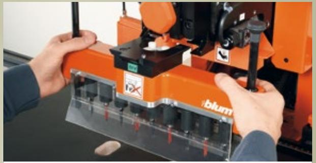
La testa portapunte è dotata di una codificazione con colori e dopo l'inserimento viene fissata senza attrezzi per mezzo di una manopola di serraggio.
