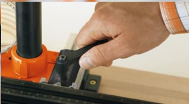
La regolazione esatta della misura di foratura si imposta con una leva di bloccaggio.
