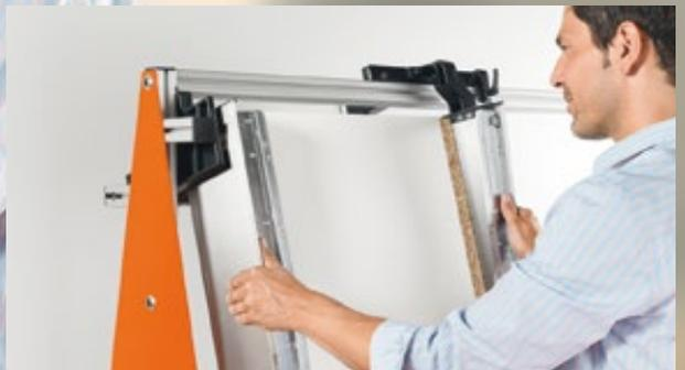
Schienale, fondo e spondine del cassetto vengono inseriti in BOXFIX P. Non sono più necessarie complicate operazioni di fissaggio.
