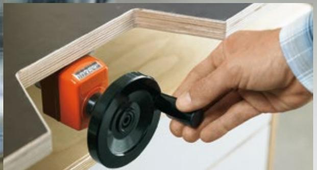
La misura di foratura si regola con precisione con l'ausilio del mandrino girevole e dell'indicatore digitale.
