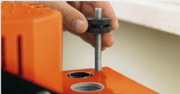
Con la vite di regolazione è possibile impostare con precisione la profondità del foro.
