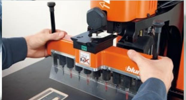
La testa portapunte, a sua volta provvista di codifica a colori, viene inserita e fissata senza attrezzi tramite manopola di serraggio.
